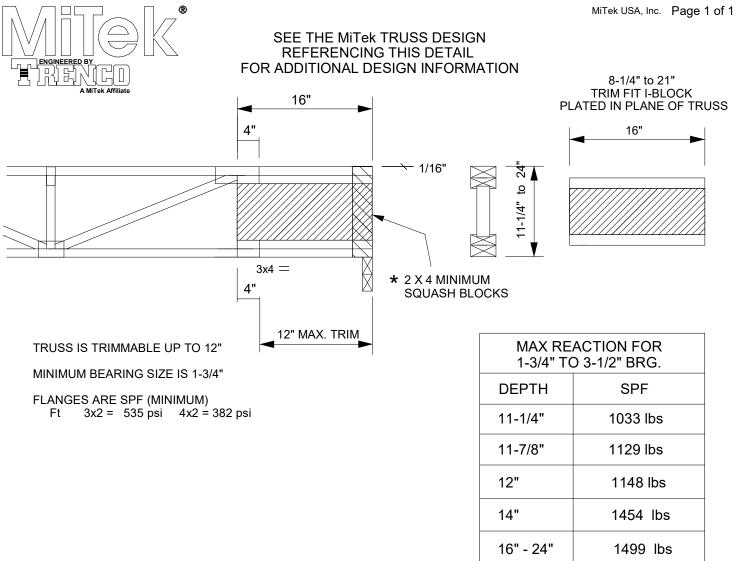
SQUASH BLOCKS REQUIRED WHEN WALL LOADS FROM ABOVE ARE PRESENT. SQUASH BLOCKS ARE TO BE 1/16" TALLER THAN TRUSS. ATTACH SQUASH BLOCKS TO EACH FACE OF TRUSS WITH THREE 10d (0.131" X 3") NAILS IN EACH END. MAXIMUM WALL LOAD IS 7612 LBS.
